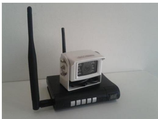
Il modello di telecamera ora utilizzato su OR10n, con il suo ricevitore. Ha la sigla WC134087CAI
