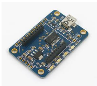
XBee USB Board, consente di collegare i moduli XBee al computer tramite la porta USB
