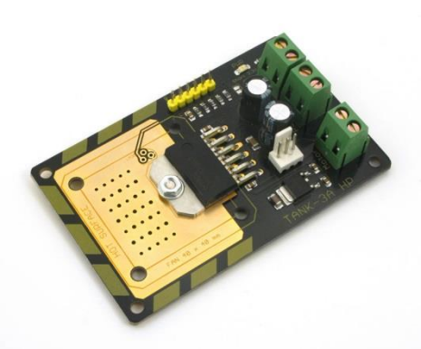
Driver motori H Bridge Tank-3A HP. Sono necessarie 2 di queste schede
