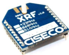
Modulo XRF della CISECO. Esistono in una sola versione: questa, con antenna a filo. Alcuni dichiarano di aver coperto fino a 3Km in aria libera usando questi moduli
