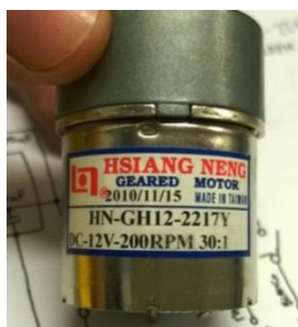
Motoriduttore Hsiang Neng utilizzato su OR10n
