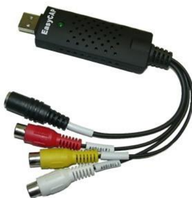
Modulo di acquisizione audio/video. Questi moduli sono basati sui chip di acquisizione STK1150 o STK1160
