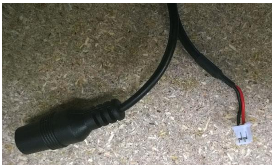
Cavetti che fuoriescono dalla telecamera. Cortocircuitando i due pin del connettore piccolo bianco a destra, l'immagine viene trasmessa non speculare
