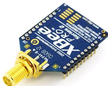
Tale connettore è molto robusto e consente di avvitare l'antenna anche direttamente al corpo dell'XBee. E' possibile montare l'antenna anche su un pannello esterno, utilizzando un cavetto di prolunga.
