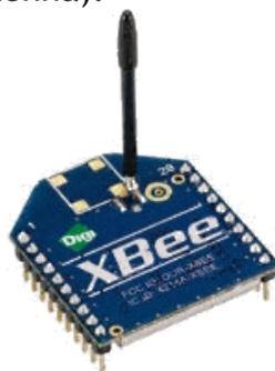
Questi due modelli appena visti, con antenna integrata (*embedded antenna*), se devono essere rinchiusi all'interno di contenitori, questi non devono essere metallici. Nel caso in cui il contenitore da usare per il proprio progetto debba essere necessariamente metallico, bisogna utilizzare un modello con antenna esterna.
