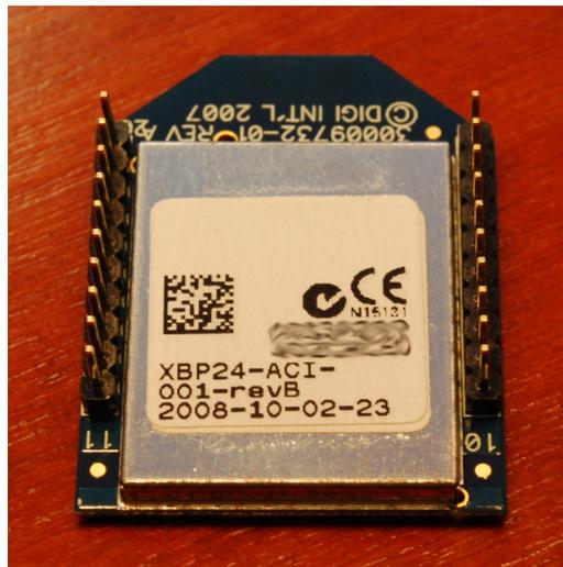
L'XBee nella foto, ad esempio, ha la sigla XBP24-ACI-001 che, capiremo tra poco, corrisponde ad un modulo XBee PRO Serie 1 con antenna a chip non destinato al mercato europeo e operante a 2.4GHz.
