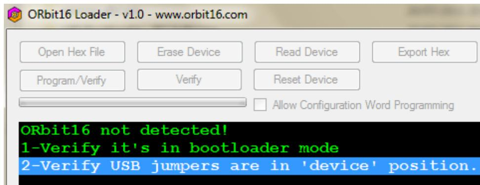
**Nota:** questo messaggio appare anche se **ORbit16™** è connessa al PC con il cavo USB ma non è attiva la modalità bootloader!
